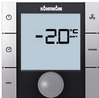
Parametr P36=1 Ustawienie temperatury zadanej \pm 3K
