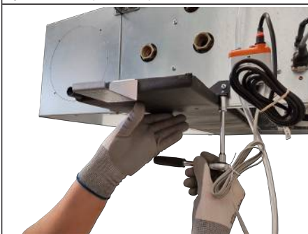
Rys. 61: Demontaż i przytrzymanie wanny kondensatu
