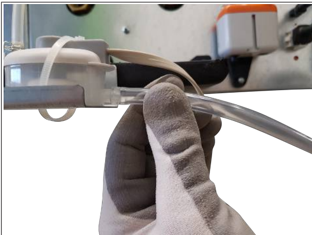
Rys. 27: Podłączanie węża ssącego
