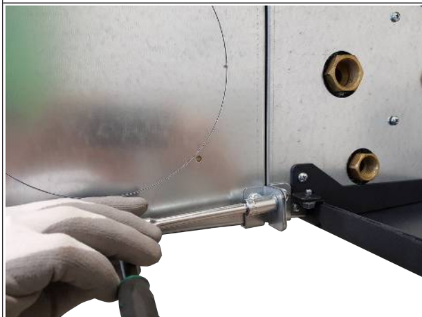
Rys. 11: Dokręcanie śrub zewnętrznych
