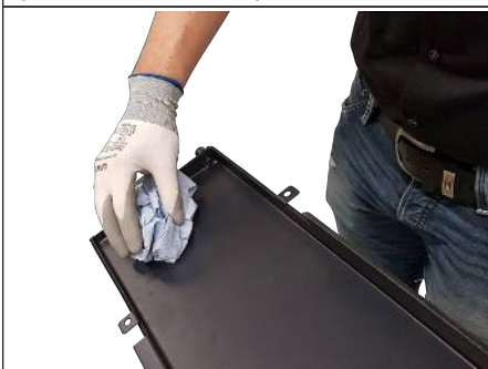
Rys. 63: Czyszczenie wanny kondensatu
