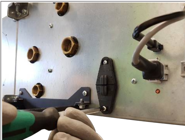
Rys. 21: Montaż uchwyty pompy
