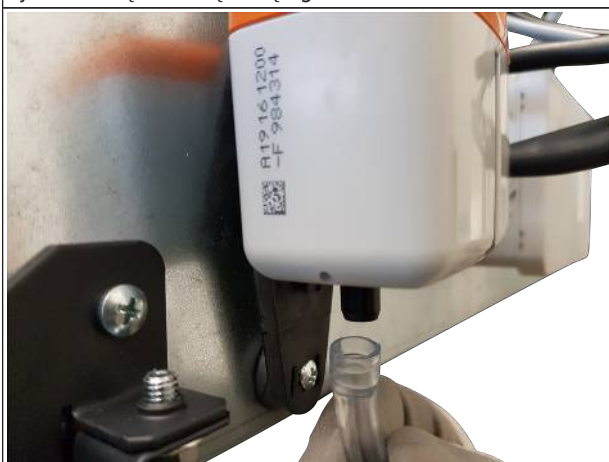
Rys. 28: Montaż węża ssącego
