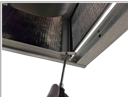
Rys. 54: Obrót blokady filtra
