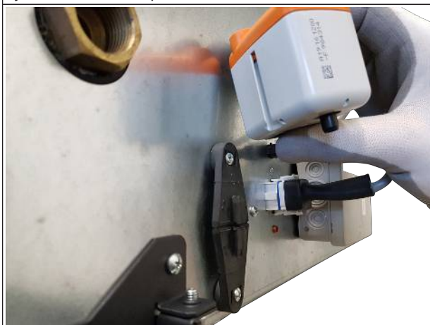
Rys. 25: Nasuwanie pompy kondensatu
