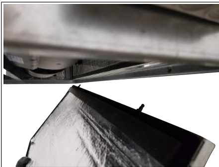
Rys. 53: Wkładanie klapy rewizyjnej
