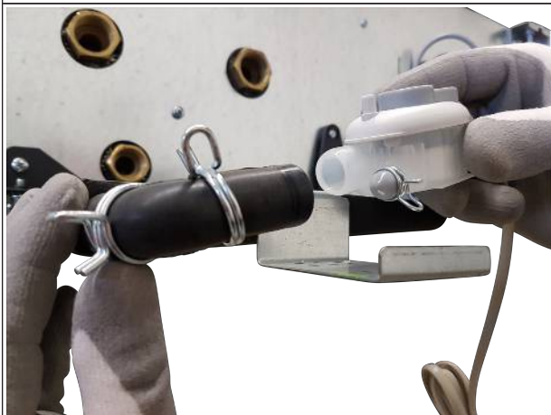
Rys. 23: Podłączanie przełącznika pływakowego
