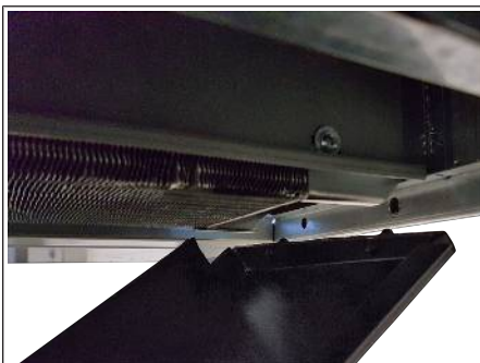
Rys. 64: Montaż wanny kondensatu
