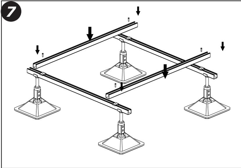
7. Legen Sie nun die C-Schienen auf die gerade angebrachten Käfigmuttern und verbinden diese mithilfe der Inbus-Schrauben, ziehen diese allerdings noch nicht fest, sodass die Schienen beweglich bleiben.
