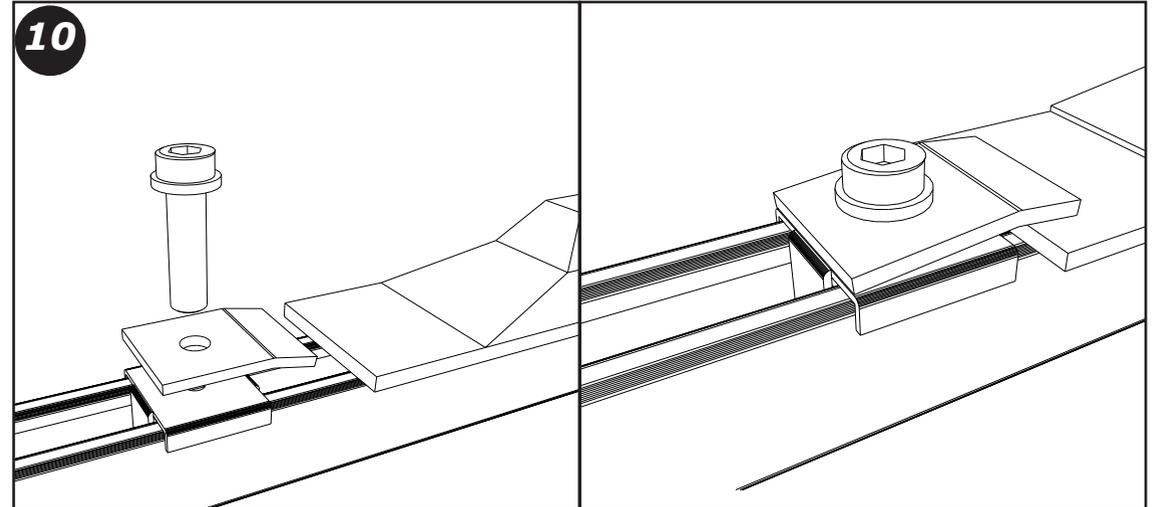
**Letzte Arbeitsschritte:** Achten Sie zusätzlich darauf, dass die Aufstellfläche in der Waage ist. Dies erreichen Sie mit der Höhenverstellung an den Stellgewinden der einzelnen Fußelemente. Fixieren Sie nun final alle Schrauben an der Konstruktion für einen sicheren und festen Stand.
