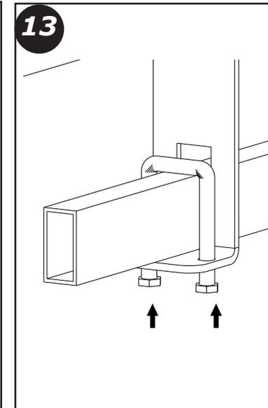
11. Haken Sie die Abhängung in die Konstruktion ein. Befestigen Sie die Abhängung lose mithilfe der Inbus-Schrauben.
