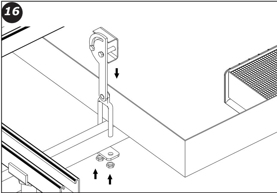
16. Fixieren Sie das Rückhaltesystem mit dem Fixierhaken-Klemmblech.
