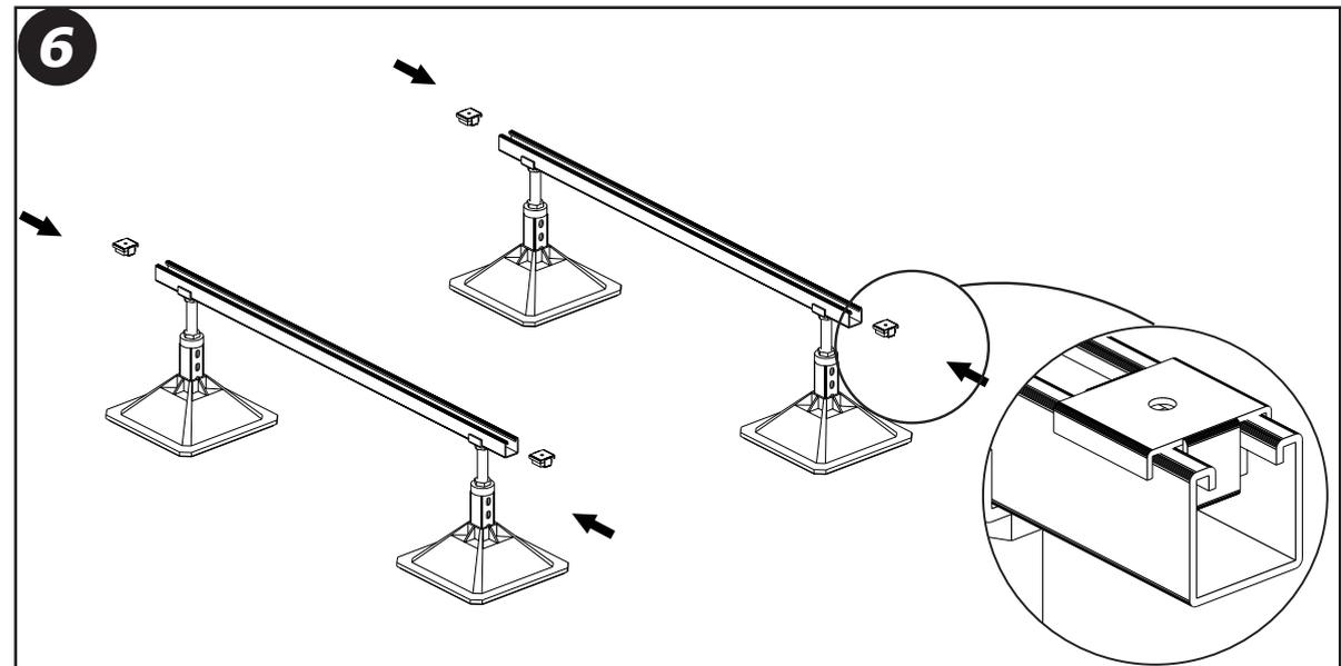
5. Legen Sie die C-Schienen auf jeweils zwei Fußelemente auf und fixieren diese fest mithilfe der Inbus-Schrauben.
