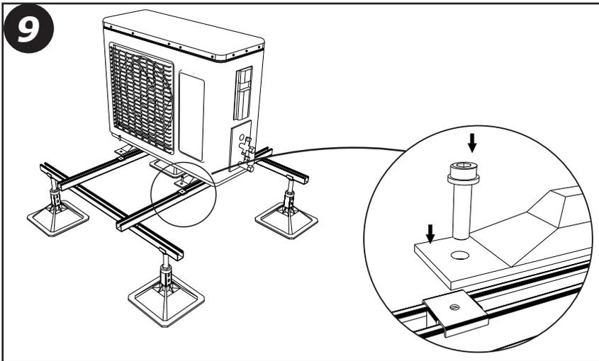
9. Stellen Sie nun die Anlage auf die C-Schienen und richten diese mittig über der Konstruktion aus.
